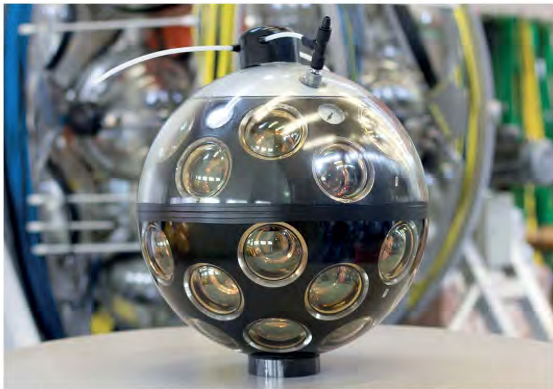
Il DOM, Digital Optical Module , è l'elemento base del rivelatore. 31 fotomoltiplicatori disposti ad occhio di mosca all'interno di una sfera di borosilicato resistente alle alte pressioni dell'ambiente marino. Il DOM è corredato con un sensore acustico ed una bussola per ricostruirne la posizione e l'orientamento sott'acqua. I dati acquisiti vengono spediti a terra da un potente laser connesso ad una rete di fibre ottiche.
